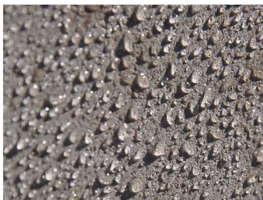
EFFECTO DE GOTA PRODUCIDO EN MATERIAL TRATADO
