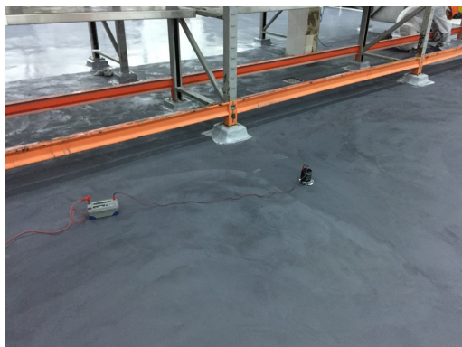
CONTROL DE RESISTIVIDAD DE FERROPUR GMF®
