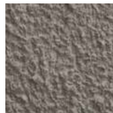
Terminación antideslizante. Carga Nro. 3. Textura gruesa. Máximo nivel de resistencia al deslizamiento.
