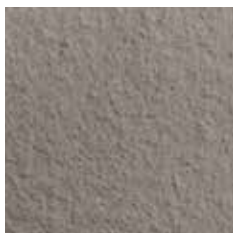
Terminación antideslizante. Carga Nro. 1. Textura fina. Nivel básico de resistencia al deslizamiento.
