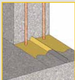
La tecnología Krystol para el tratamiento impermeabilizante de juntas le asegura una protección permanente ya sea con la instalación de triangulo interno o de la banda hidroexpansiva junto la lechada de Krystol Treatment.
