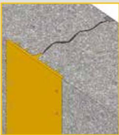
La banda inductora de grietas "Kryton Crack Inducing Waterstop" induce una grieta controlada que se empaqueta posteriormente con un mortero impermeable, que asegura una protección permanente e integra la tecnología Krystol a la matriz del concreto.
