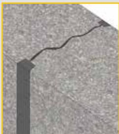
Dos canaletas alineadas pueden generar una grieta controlada, al empaquetar estas canaletas con un mortero impermeable externo, se asegura una protección impermeable y permanente integrando a la matriz del concreto la tecnología Krystol.
