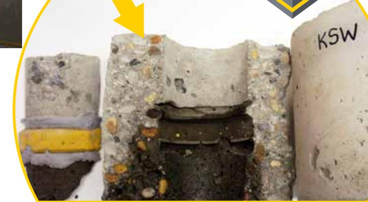
La Banda Hidroexpansiva Krytonite ha probado resistir una presión hidrostática de hasta 265 ft columna de agua (8 bar) bajo el método DIN 1048-5. Su presión de expansión sella juntas constructivas y detiene el paso del agua.
